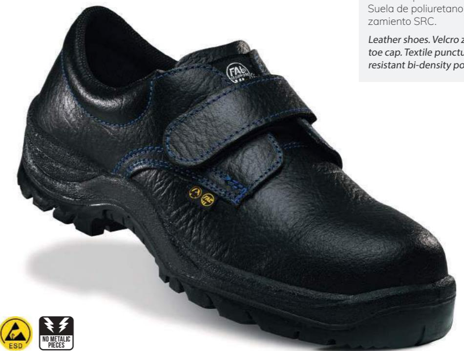
Zapato de piel. Cierre con velcro. Puntera no metálica Vincap. Plantilla antiperforación textil. Suela de poliuretano bidensidad con nivel de deslizamiento SRC.
