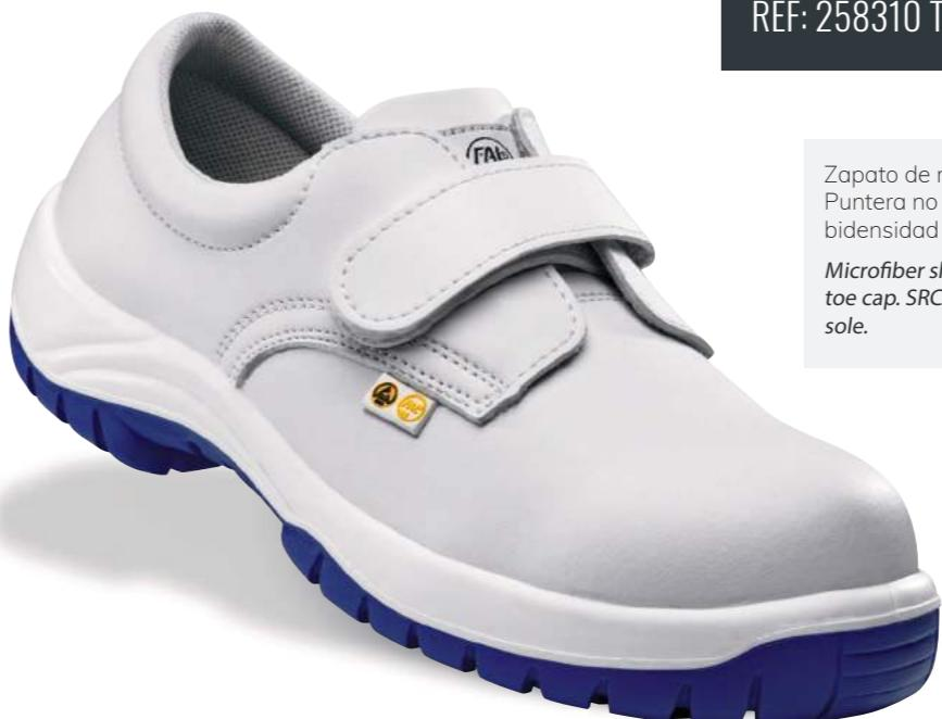
Zapato de microfibra. Cierre de velcro. Puntera no metálica Vincap. Suela de poliuretano bidensidad con nivel de deslizamiento SRC.
