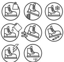
Zapato de piel serraje. Puntera no metálica Vincap. Plantilla antiperforación textil. Suela de poliuretano bidensidad con nivel de deslizamiento SRC.
